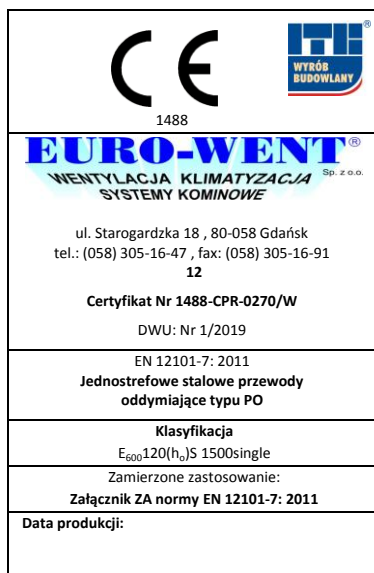
Rysunek 10. Oznakowanie CE stosowane przez firmę EURO – WENT Sp. z o. o. dla przewodów oddymiających
